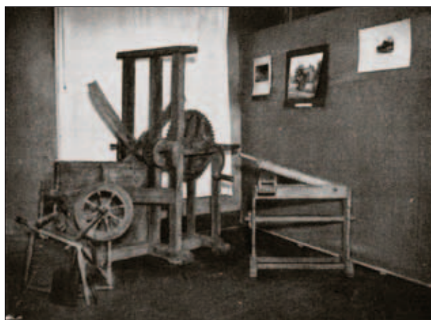
Flachsbrechmaschine aus den Walddörfern, aus der heimatkundlichen Ausstellung im Gasthaus C. Paape in Großhansdorf
